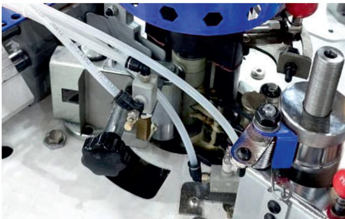
Для получения максимально качественного результата приклеивания кромки станок оборудован форсунками для подачи разделительной жидкости в зону контакта плоскости заготовки и свеса кромки.
